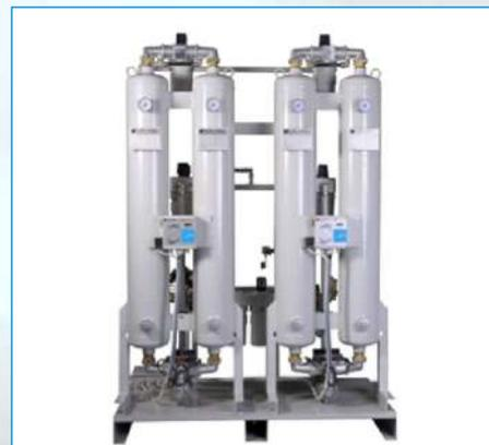
Дуплексная система подготовки сжатого воздуха включает два осушителя сжатого воздуха адсорбционного типа / рефрижераторного типа, а также необходимые фильтры, анализаторы температуры конденсации, переключатель контроля газа и распределительный ящик, синоптик для каждой пневмолинии.
